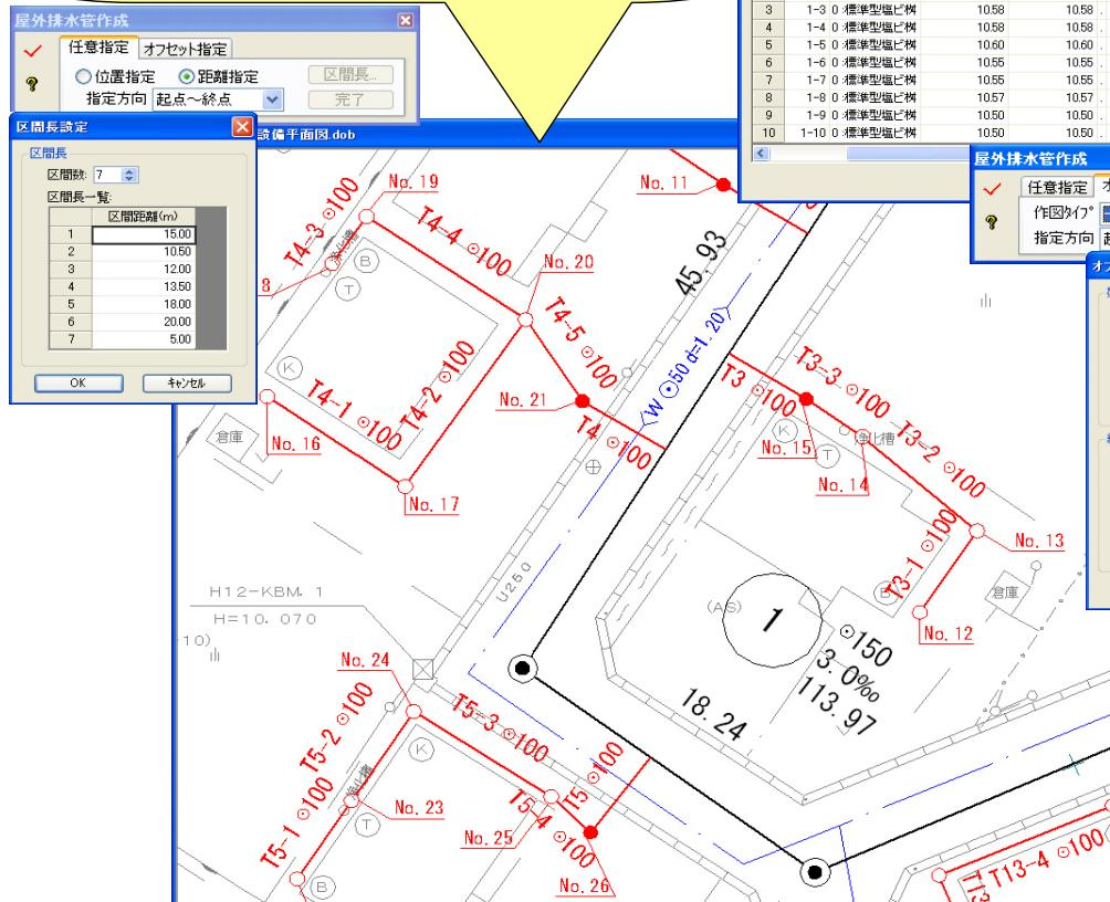
測量データ(SIMAデータ)からの読み込みによる路線平面図新規作成時にも、接続タイプが「樹引き」の取付管要素、および屋外排水管要素の自動作成が可能です。
