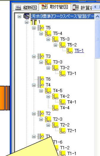
排水設備管から接続本管まで、運動した高さの検討が行えます。また系統状況をツリー構造でも確認いただけます。
