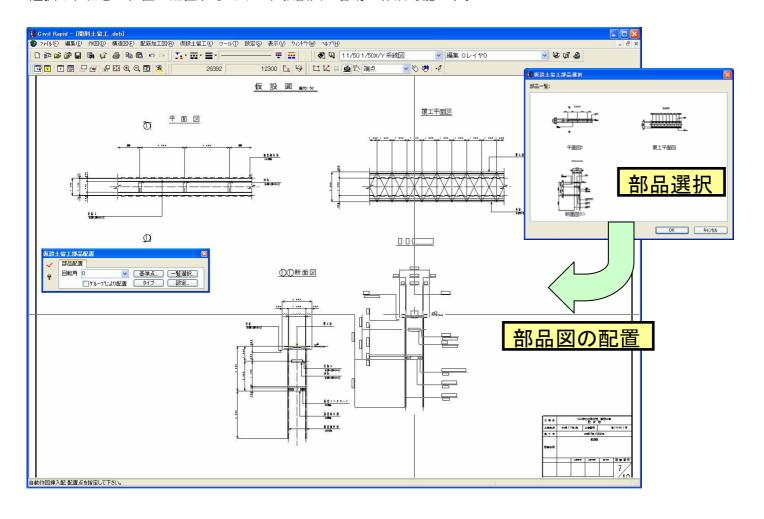
各部品図は、寸法や注釈が自動的に作図され、基礎 コンクリートや基礎砕石を作図することも可能です。 注釈位置が、他の注釈と重なる場合は、自動的に重 ならない位置に作図されます。
