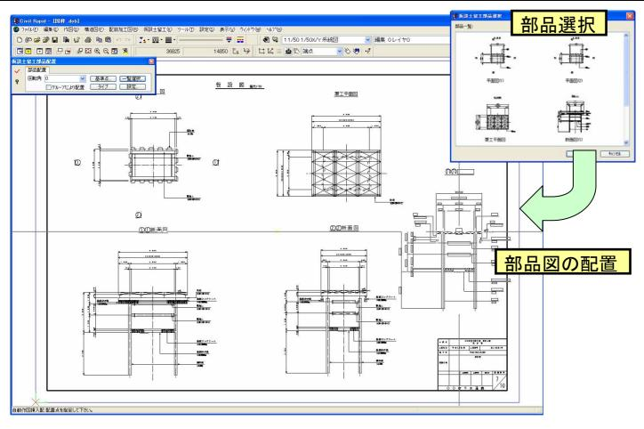
入力が完了すると、仮設土留工部品配置のダイアログが表示されます。一覧選択で作図したい図面を部品一覧より 選択し、任意の位置に配置するだけで、仮設図が容易に作成可能です。
